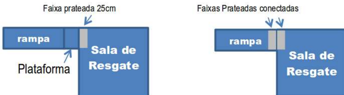
Figura 7 – Faixa prateada na entrada da sala de resgate com e sem plataforma.
